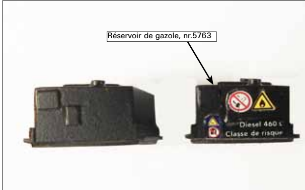
Photo 33: Réservoir de gazole avec inscriptions
